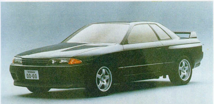
▲プロトタイプ最終案。専用のラジエータグリル、大型インタークーラーの冷却を確保するために大きく口を開けたフロントバンパー、追力のリアリスターフェンダーなど、ポテンシャルを最大限に発揮する流みをもっている
