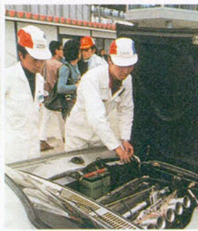
▶ 直列6気筒DOHC、24バルブ、1989ccのキャパシティの鍛え抜かれた心臓は、当時の2&としてはスバ抜けたパフォーマンスを発揮した
