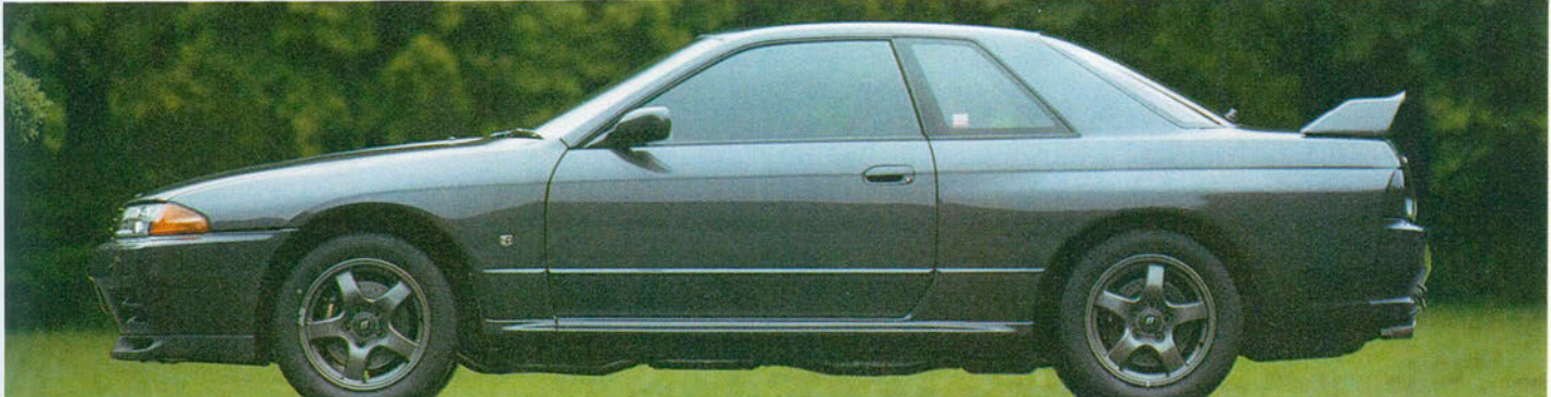
▲プロトタイプ最終案。専用のラジエータグリル、大型インタークーラーの冷却を確保するために大きく口を開けたフロントバンパー、追力のリアリスターフェンダーなど、ポテンシャルを最大限に発揮する流みをもっている
