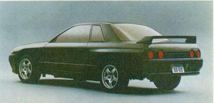
▲プロトタイプ最終案。専用のラジエータグリル、大型インタークーラーの冷却を確保するために大きく口を開けたフロントバンパー、追力のリアリスターフェンダーなど、ポテンシャルを最大限に発揮する流みをもっている
